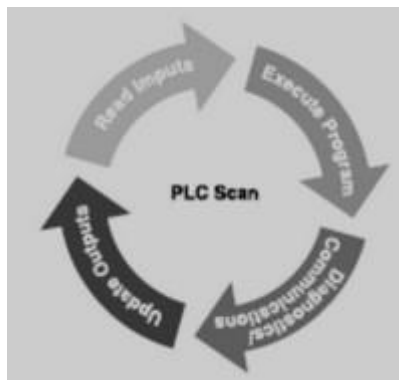
Hình 2. 21 Vòng quét CPU PLC S7-200
