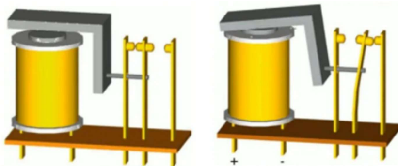
Hình 3.11 Tiếp điểm NO và NC của Role
