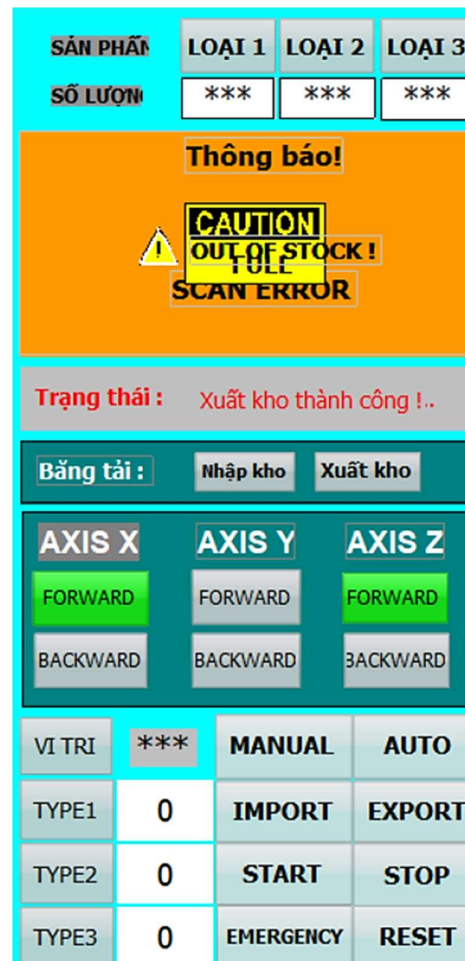
Hình 5.14 Bảng điều khiển chế độ tự động trên WinCC
