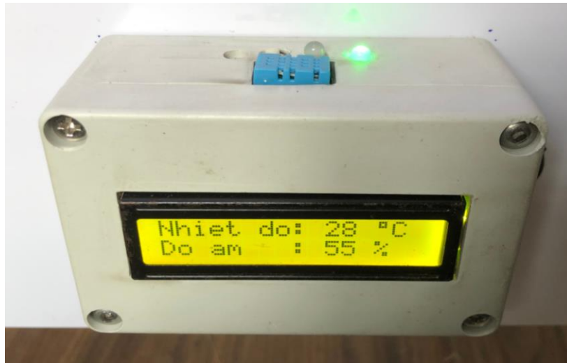
Hình 3. 18: Module giám sát nhiệt độ, độ ẩm
