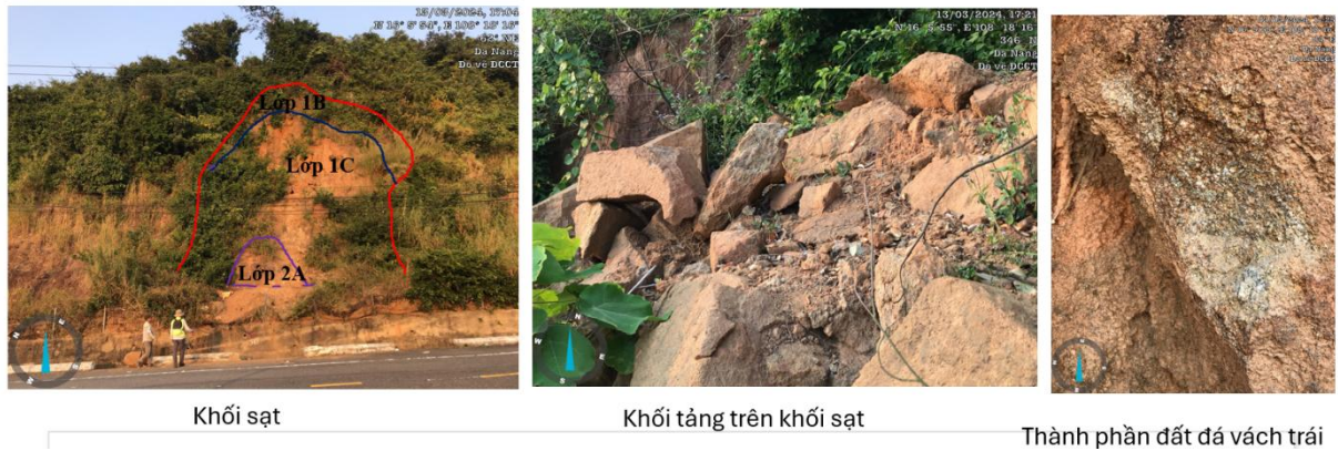
Hình 2.26. Cấu trúc địa chất khối sạt và thành phần đất đá vách sạt s25
