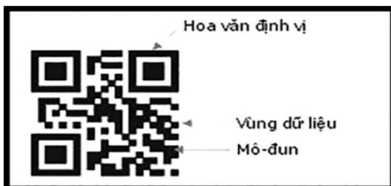
Hình 1.6 Hình ảnh cấu trúc QR Code [5]
