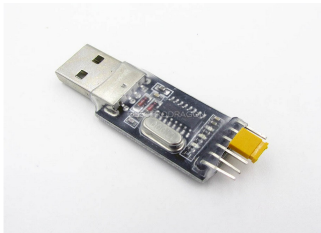
Hình 3.10 Hình ảnh thực tế UART USB to TTL CH340G [17]
