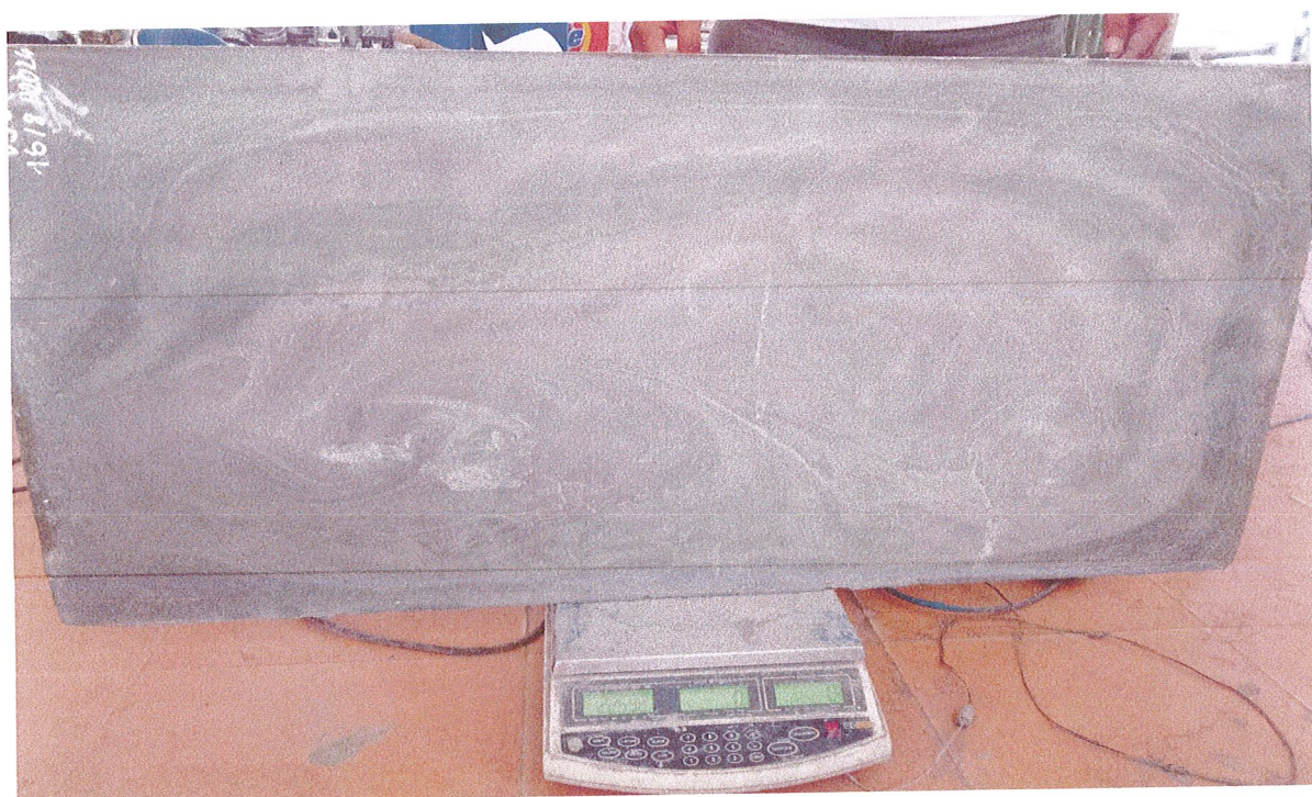
Hình 4. Khối lượng của tấm bê tông nhẹ
