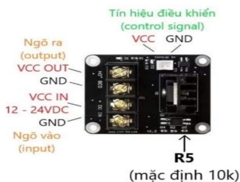
Hình 3.2 Module công suất MOSFET HA 210N06-TH325
