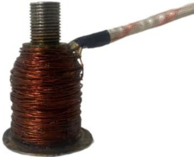
Hình 3.21 Quấn cuộn cảm solenoid
