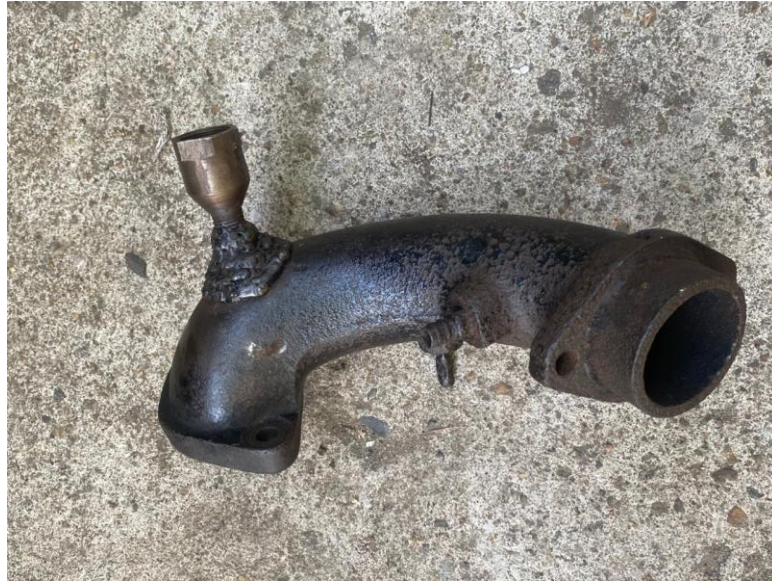
Hình 3.26 Đường ống nạp sau khi cải tạo
