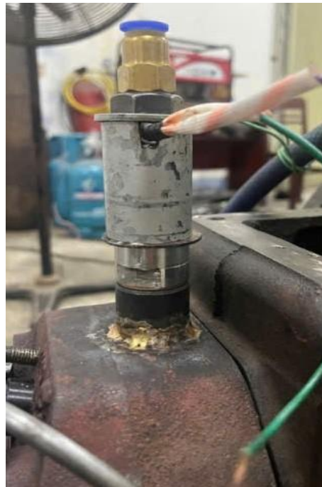
Ảnh 3: Ảnh vòi phun lắp đặt trên nắp máy
