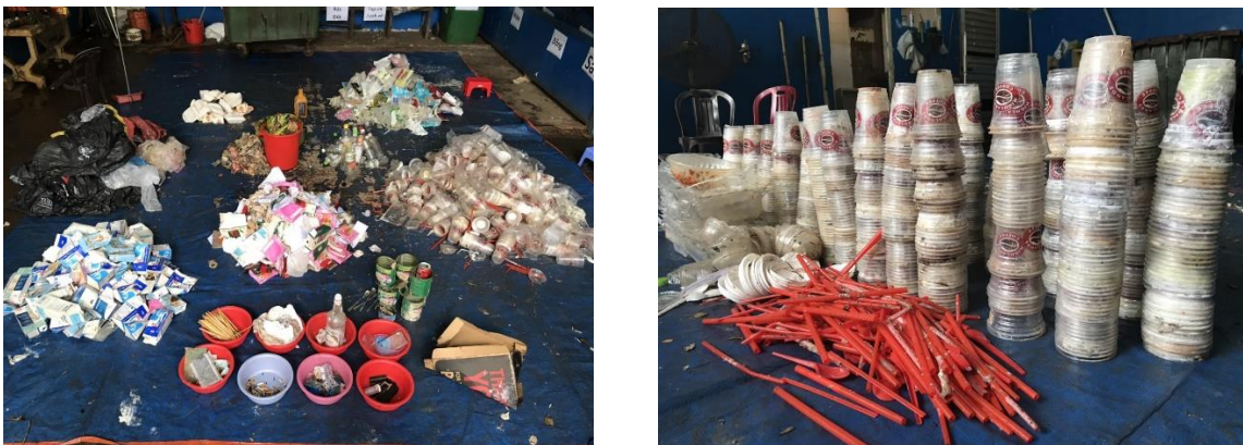
Hình 14 (a) & (b). Thực hiện giảm thể tích mẫu theo phương pháp “Hình nón và một phần tư”
