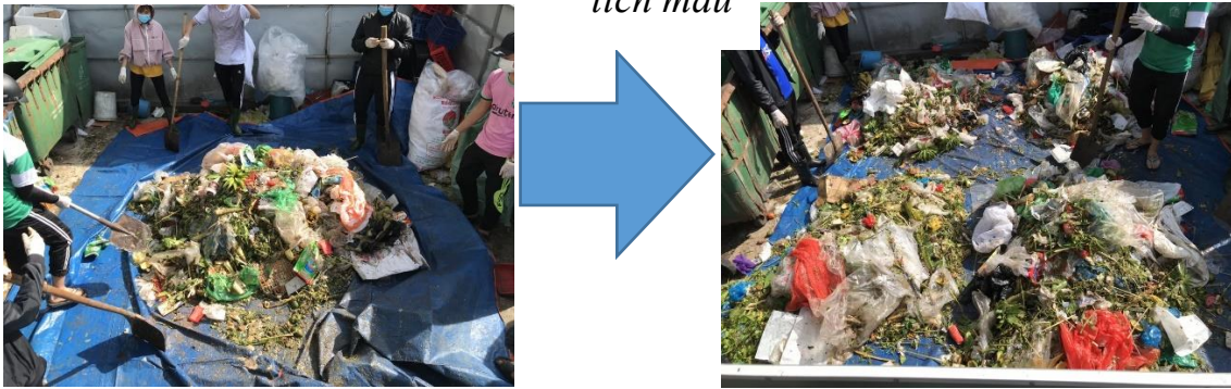
Hình 14 (a) & (b). Thực hiện giảm thể tích mẫu theo phương pháp “Hình nón và một phần tư”
