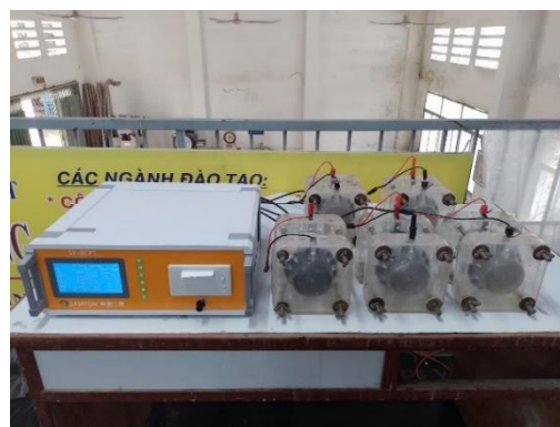
Thí nghiệm thấm clorua và điện trở suất của các mẫu bê tông
