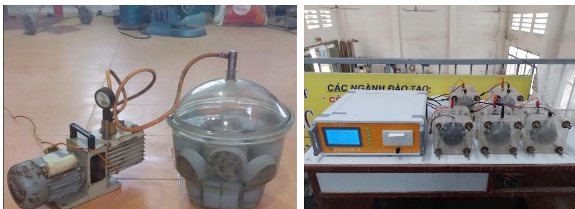
Hình 3.6 Thí nghiệm thấm clorua và điện trở suất của các mẫu bê tông
