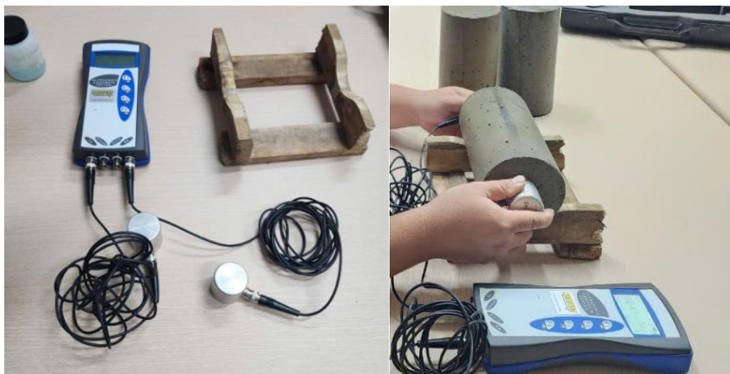
Hình 3.5 Thí nghiệm xác định vận tốc xung siêu âm của các mẫu bê tông
