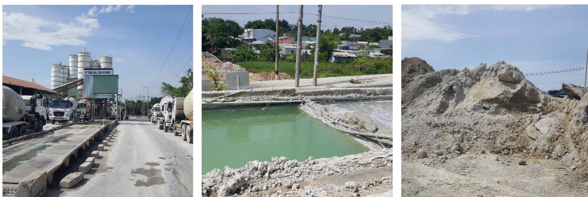
BTBT được thu từ các bể lắng và chất đông tại một trạm trộn BTXM ở TP. Đà Nẵng, Việt Nam
