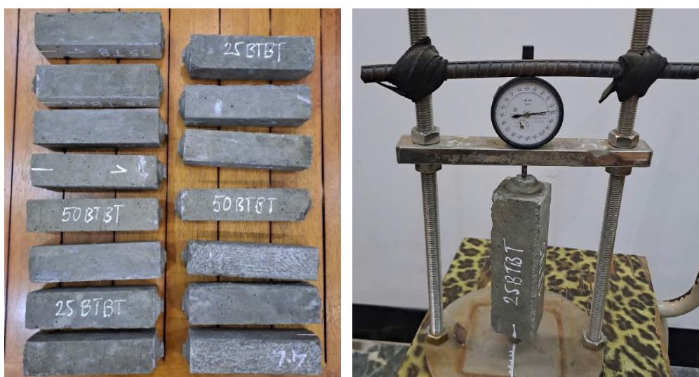
Hình 3.7 Đo CNK của các mẫu bê tông
