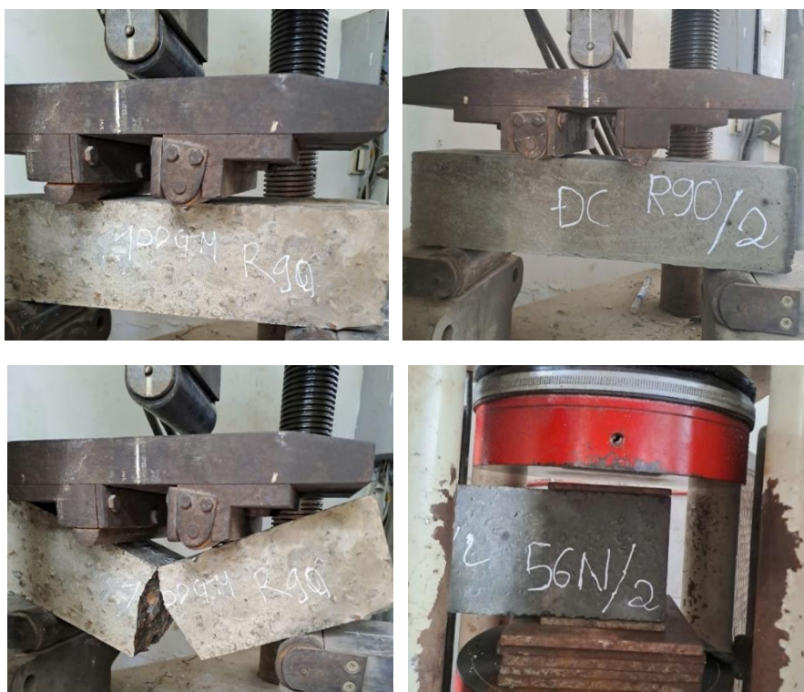
Hình 3.4 Thí nghiệm xác định cường độ kéo uốn và nén của các mẫu bê tông
