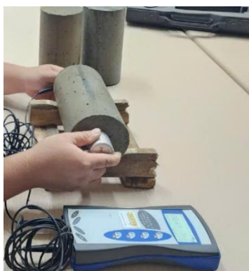
Thí nghiệm xác định vận tốc xung siêu âm của các mẫu bê tông
