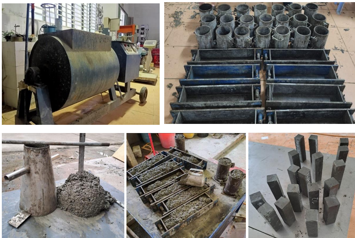
Hình 3.1 Chuẩn bị khuôn, thử độ sụt và đúc các mẫu bê tông
