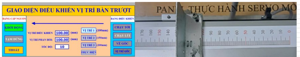
Hình 5.12: Kết quả thực nghiệm di chuyển bàn trượt đến vị trí 1
