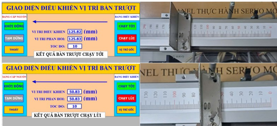
Hình 5.10: Kết quả di chuyển bàn trượt chạy tới và lùi từ vị trí gốc
