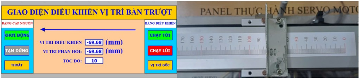
Hình 5.8: Kết quả thực nghiệm di chuyển bàn trượt chạy lùi
