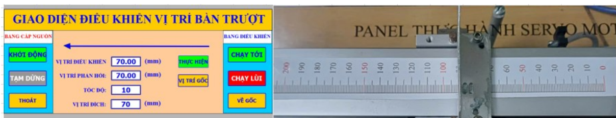
Hình 5.16: Thực nghiệm di chuyển bàn trượt đến một vị trí bất kỳ (70 mm)
