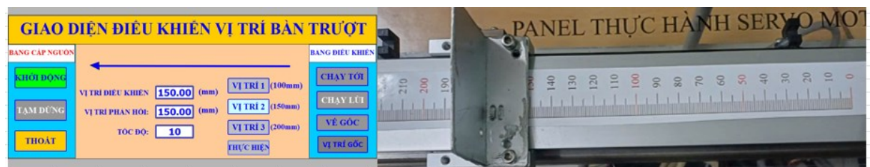
Hình 5.13: Kết quả thực nghiệm di chuyển bàn trượt đến vị trí 2
