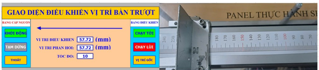
Hình 5.7: Kết quả thực nghiệm di chuyển bàn trượt chạy tới
