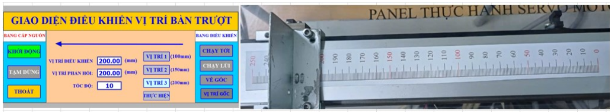
Hình 5.14: Kết quả thực nghiệm di chuyển bàn trượt đến vị trí 3
