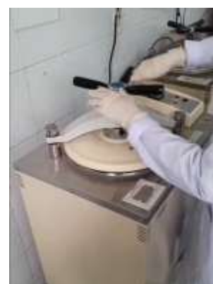
Hình 9. Nồi hấp autoclave (SA-300VL Sturdy, Đài Loan)
