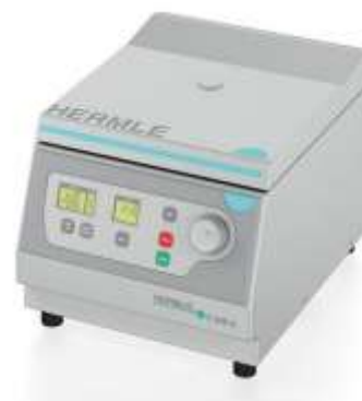
Hình 6. Máy ly tâm (Z206A, Hermle-Đức)
