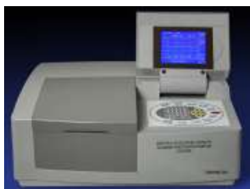
Hình 5. Máy đo quang phổ UV-Vis (UVD-2950, Labomed-Mỹ)
