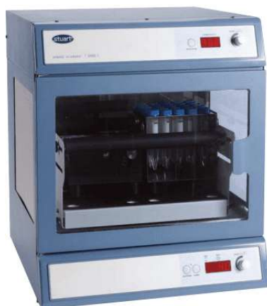
Hình 2. Máy lắc có gia nhiệt (cole-Parmer SI600, Anh)
