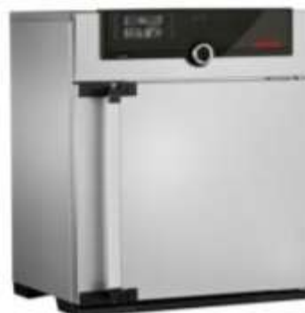
Hình 3. Máy sấy (UN110, Mettler, Đức)
