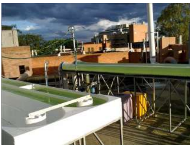
Hình 1.9. Hệ thống nuôi cấy vi tảo hai giai đoạn từ hệ thống PBR đến ORP quy mô pilot
