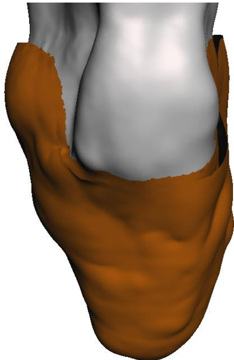
Hình 3.14 – Offset bề mặt trong của ổ cắm
