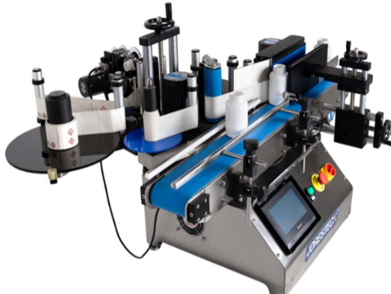
Hình 1.9 Máy dán nhãn tự động có bộ mã hóa cho chai tròn
