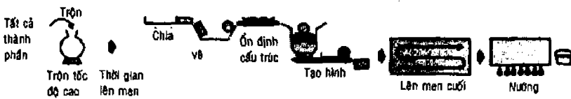
Hình 3.1.2.2 Sơ đồ thiết bị bốn quy trình công nghệ thông dụng để sản xuất bánh mì
