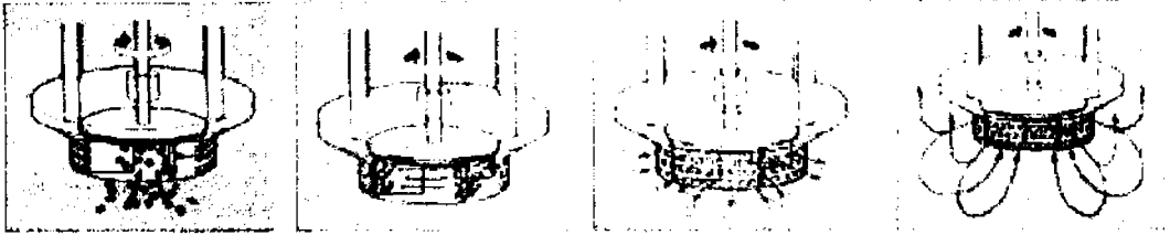
Hình 3.9.3.5 Nguyên lý hoạt động của thiết bị nhũ hóa Silverson Batch Mixer
