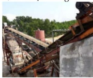
Rửa cát bằng nước tại sàng rung
