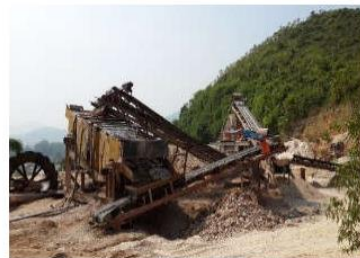
Rửa cát bằng nước tại sàng rung
