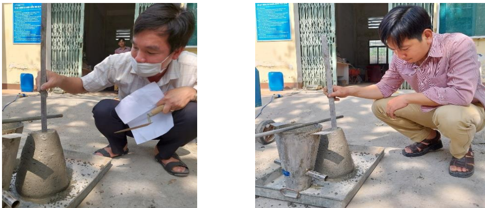
Hình 3. 3. Thí nghiệm đo độ sụt
