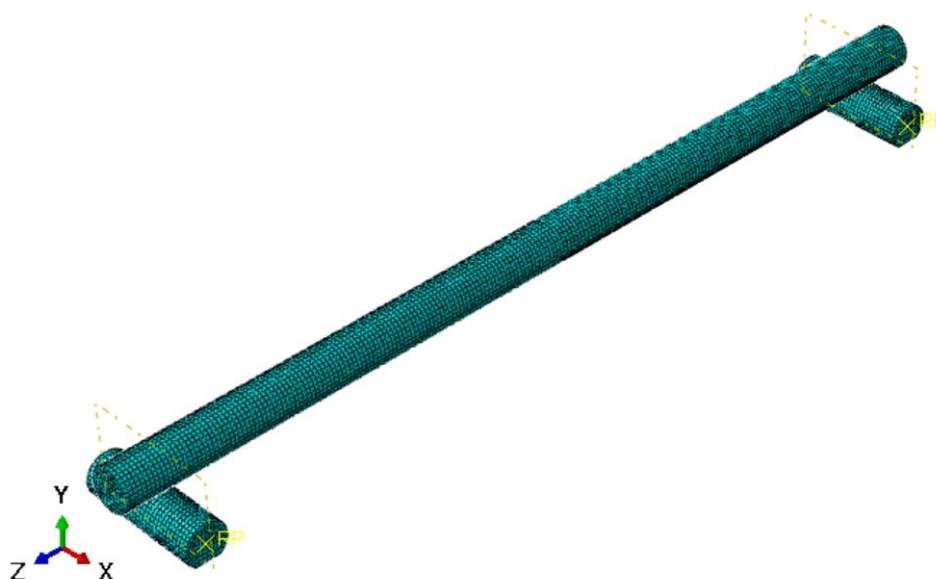
Hình 3. 21 Phân tử hữu hạn mô hình (lưới) với phần tử kích thước 1mm đối với dầm chịu uốn 3D ( d=10\text{ mm} )
