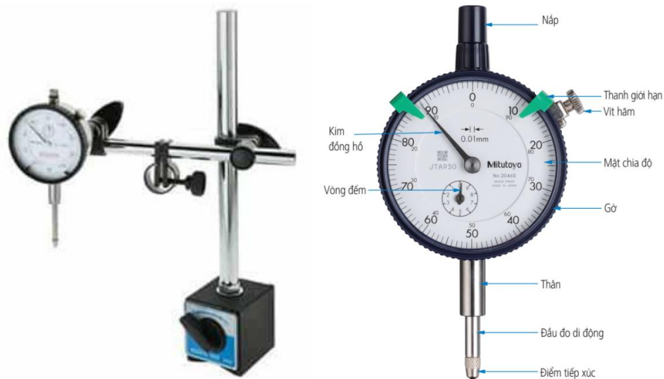
Hình 3. 6 Bộ đồng hồ so để đo chuyển vị trong thí nghiệm
