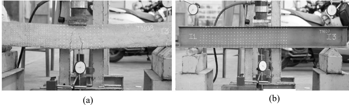
Hình 1. 7 Mô hình thí nghiệm đo chuyển vị của dầm bê tông cốt thép (a) và dầm thép (b)
