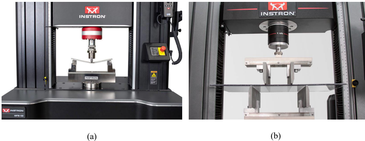
Hình 1.1 Mô hình uốn 3 điểm (a) và 4 điểm (b) trên máy kéo nén vạn năng INSTRON [8]
